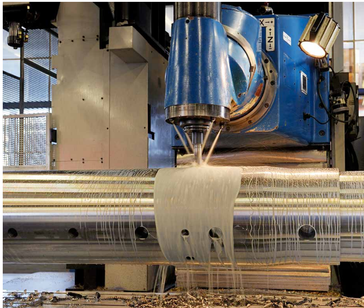
HET FREZEN VAN EEN TURBINE-AS VOOR DE GAS-/OLIEINDUSTRIE
